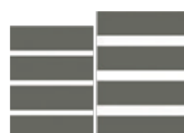
Barreaux de 70 mm espacés de 15 ou 30 mm
