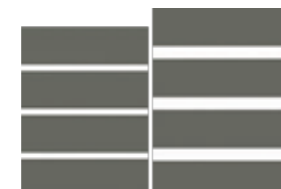
Barreaux de 94 mm espacés de 15 ou 30 mm
